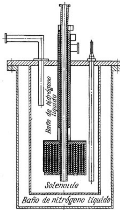
*Figura 11. Se puede disminuir sustancialmente las pérdidas eléctricas en los solenoides, colocándolos en ambiente de temperatura baja. En este caso disminuye considerablemente la resistencia de los devanados del conductor.*
