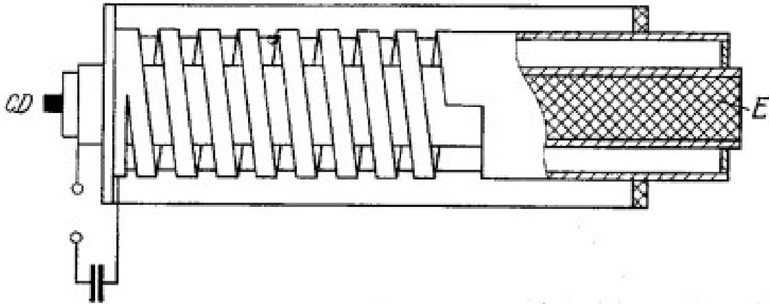
*Figura 16. Principio de funcionamiento del generador magnetocumulativo MC-2 (la carga de trilita se utilizó para la compresión de la zona que contiene flujo magnético): CD - cápsula detonante; E - explosivo.*
