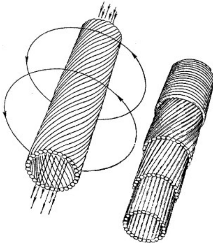
*Figura 13. Devanados arrollados de este modo casi no sufren de la terrible plaga, de los electroimanes potentes: en ellos se disminuyen los esfuerzos que surgen debido a la presión del campo magnético.*
