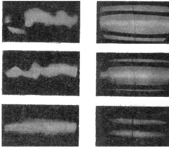
*Figura 25. Cuadros de la inestabilidad de plasma. Lamentablemente, de momento no se ha logrado hallar tal forma de campo magnético que permita al plasma mantener durante mucho tiempo su forma sin tocar las paredes del recipiente.*
