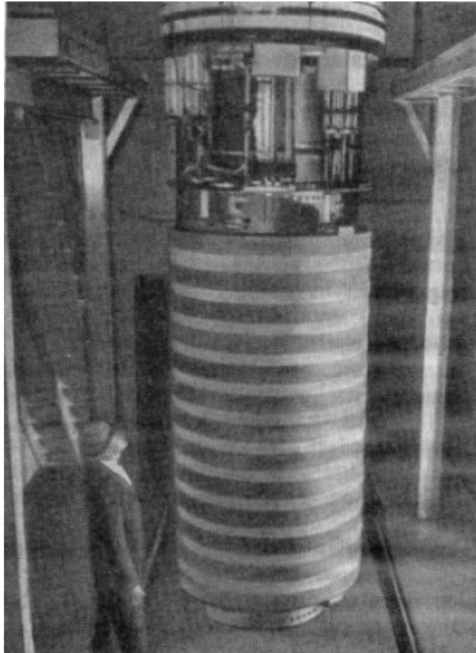
*Figura 33. El imán superconductor más grande del mundo. Su largo es de 3 m; diámetro interior, 30 cm y el campo magnético, 40 mil Oe. Las pérdidas de energía eléctrica en ese imán son incomparablemente menores que en los imanes no superconductores de parámetros idénticos.*
