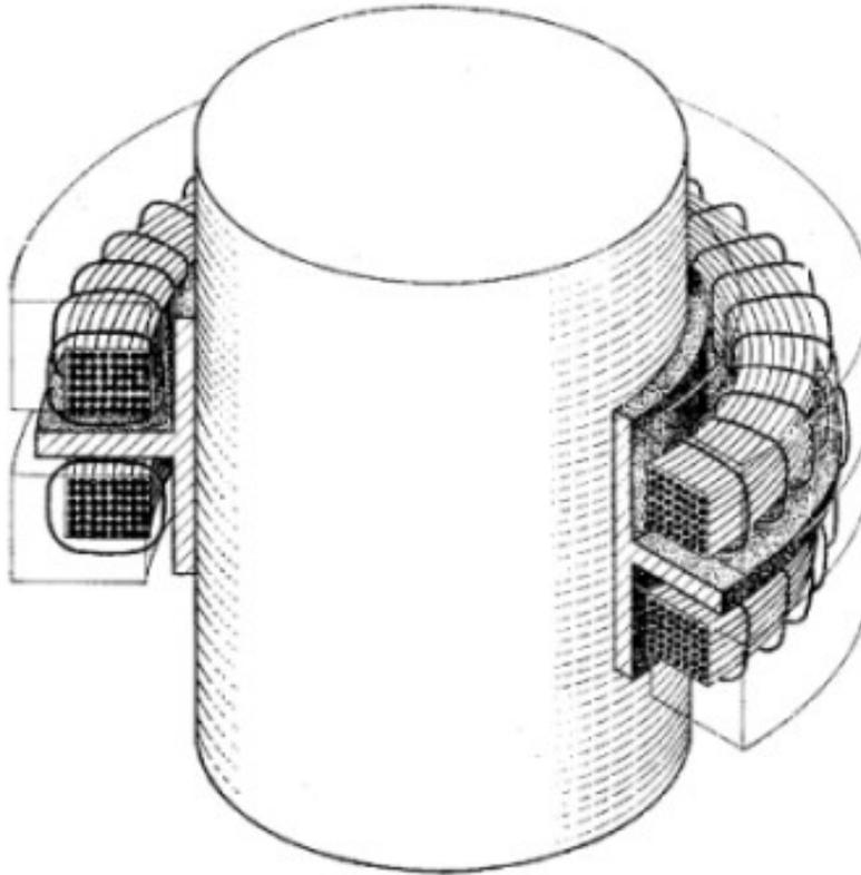
*Figura 32. El diamagnetismo de los superconductores se puede usar para crear cojinetes sin rozamiento, en los cuales el eje no toca los apoyos, sino que las líneas de fuerza del campo magnético lo mantienen en suspenso.*
