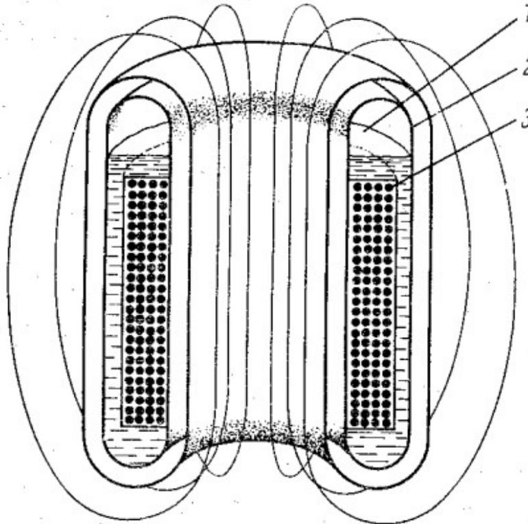
*Figura 31. Si el frasco Dewar, en el cual se almacena helio líquido tiene forma tubular, el campo magnético del devanado superconductor que se halla a temperatura de helio líquido puede utilizarse también a temperatura ambiente: 1. helio líquido; 2. espacio vaciado; 3. devanados superconductores.*
